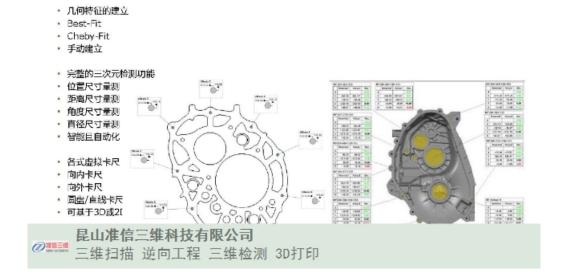
所谓逆向工程技术,是指用一定的测量手段对实物或模型进行测量,根据测量数据通过三维几何建模方法 重构实物的CAD模型的过程。
